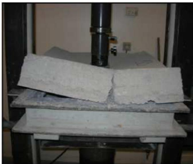
Essai d'absorption d'énergie
