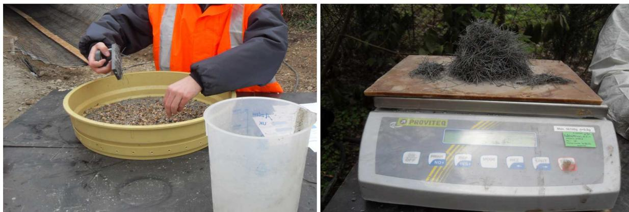
À noter : lors des essais de convenance, les teneurs en fibres mesurées pour un béton projeté dans une caisse présentaient des variations difficilement compréhensibles alors que celles obtenues à partir de prélèvements « in situ » étaient remarquablement homogènes. Il a en conséquence été décidé de contrôler le dosage en fibres pendant les travaux à partir de prélèvements in-situ. Cette pratique présentait en outre l'avantage de moins perturber le poste de travail au moment des contrôles.
