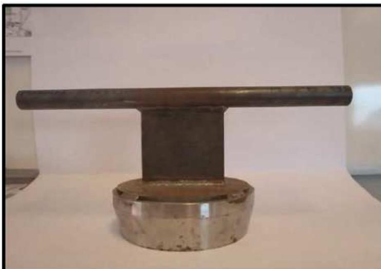
**Exemple de coupelle de prélèvement de 1l**
