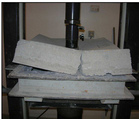
Essai de capacité d'absorption d'énergie
