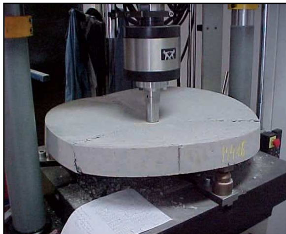
Essai de flexion 3 points sur dalles rondes
