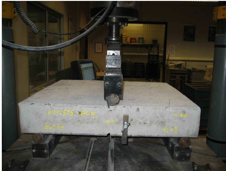
Essai de flexion 3 points sur dalle entaillée
